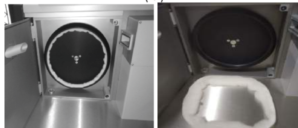
(d) Rotor /Fibre collector with fibre/sliver sample
